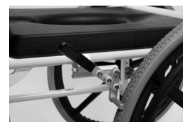
Bild 12: Kontrollieren ob die Bremsen greifen
