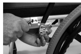
Bild 11: Die Bremsen am Rahmen montieren
